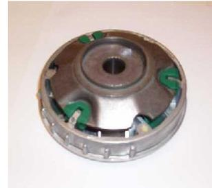
L'originale gruppo semipuleggia mobile motrice, installato di serie sul maxi scooter, è stato progettato per fornire le migliori prestazioni (accelerazione e consumo) sia nella marcia in pianura che in salita
